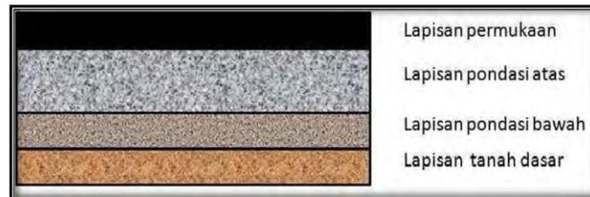
Gambar 3.1 Kontruksi Perkerasan Lentur
